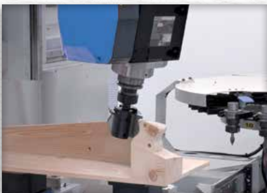
Liquid cooled electrospindle. Electromotor con enfriamiento liquido Vloeistofgekoelde freesmotor.
