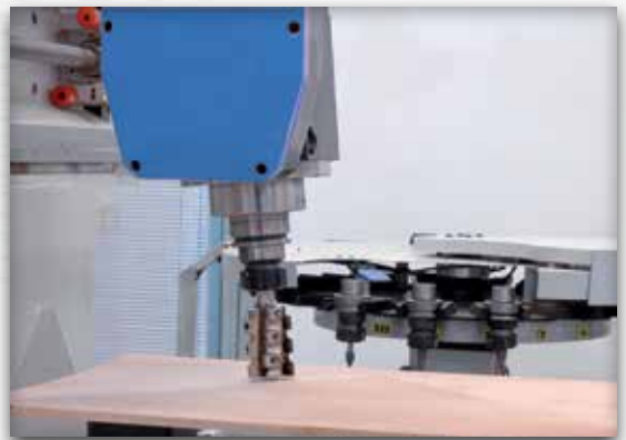
Routing unit with double rotation for 5 axis machining. Grupo de fresado birotatorio para mecanizaciones a 5 ejes. 5 assige freesmotor met TCP.
