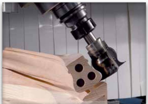
Liquid cooled electrospindle. Electromotor con enfriamiento liquido Vloeistofgekoelde freesmotor.
