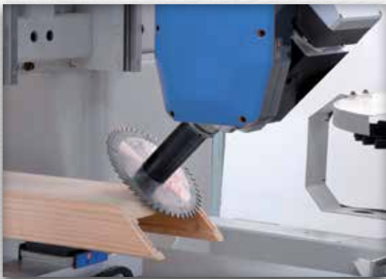
Routing unit with double rotation for 5 axis machining. Grupo de fresado birotatorio para mecanizaciones a 5 ejes. 5 assige freesmotor met TCP.
