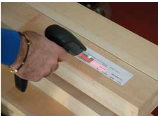
Lettura del codice a barre sul grezzo nel magazzino Bar code reading on raw material in warehouse Lecture du code - barres sur les pièces brutes de 4 faces Strichkode-Lesung auf den Rohteilen
